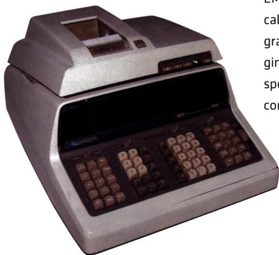
76. kép: HP 9100B asztali számológép, mágneskártyás „főttárral” Picture 76: HP 9100B desk computer, with magnetic card “main memory”
