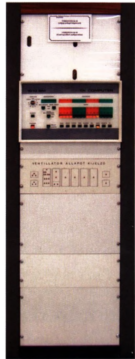
48. kép: Az R10 számítógép központi egysége
