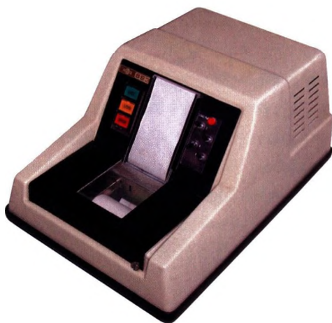
78. kép: EMG mozaiknyomtató Picture 78: EMG mosaic printer
