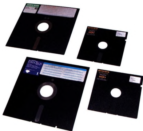
58. kép: Nagy (8") és közepes (5.25") floppy lemezek Picture 58: Big (8") and middle (5.25") floppy discs
