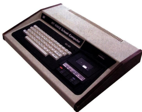
95. kép: HT 1080Z iskola-számítógép Picture 95: HT 1080Z school computer
