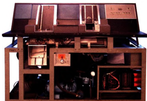
45. kép: Az ICT 1905 számítógép lyukkártyás egysége
