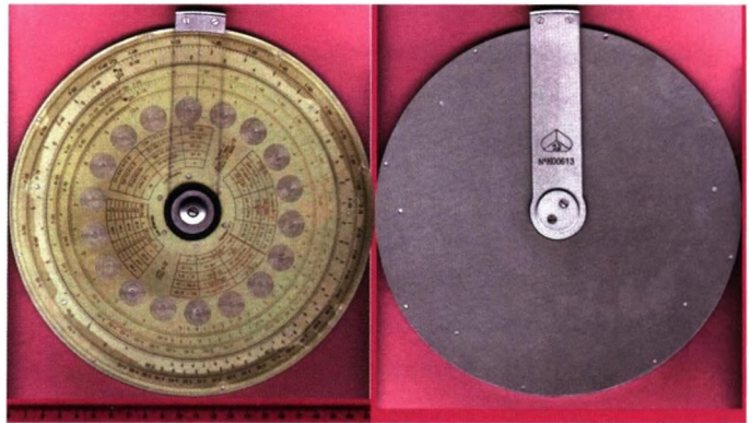
4. kép: Logartárcsa Picture 4: Circular slide rule
