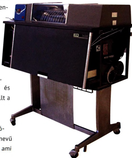
64. kép: IBM 1403 típusú íróláncos sornymatató Picture 64: IBM 1403 type chain printer
