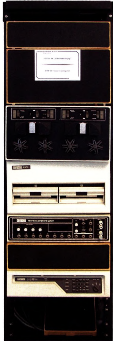
51. kép: PDP 11/34 számítógép Picture 51: PDP 11/34 computer
