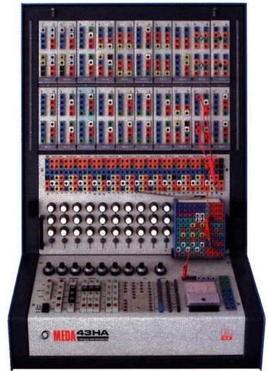
10. kép: MEDA elektronikus analóg számológép Picture 10: MEDA electronic analogue calculator
