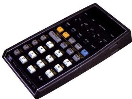
74. kép: HP 65 programozható asztali számológép, a PC-k őse, (az MMKM Tanulmánytárában)
