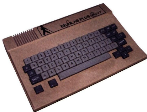
97. kép: Brailab: vakok számára átalakított Homelab házi számítógép
